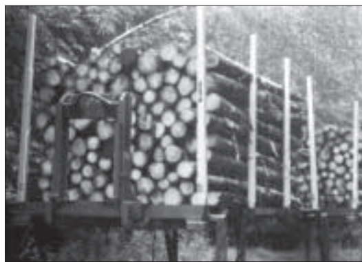
Direktbeladung eines Euroflats durch den Forwarder
