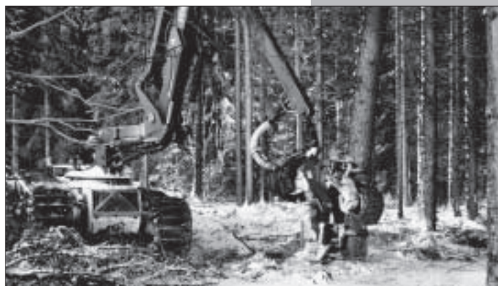
Abb. 2: Der ferngesteuerte Harvester
